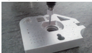
Ejemplo de montaje de la punta de contacto
