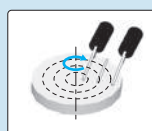
Ejemplo de verificación usando un instrumento de medición de redondez
