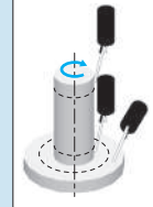
Ejemplo de verificación usando un instrumento de medición de redondez
