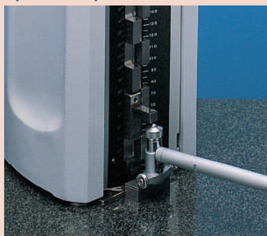
Ajuste a cero del Bore gage
