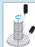
Ejemplo de verificación usando un instrumento de medición de redondez
