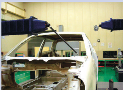
Ejemplo de medición para el tipo dual (Uso simultáneo de palpador de activación por contacto y palpador láser de línea)
