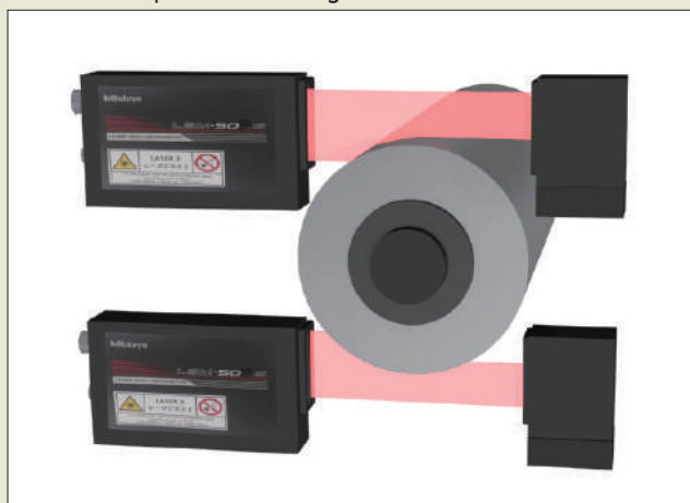
Sistema Dual para medir una gran diámetro exterior
