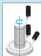
Ejemplo de verificación usando un instrumento de medición de redondez
