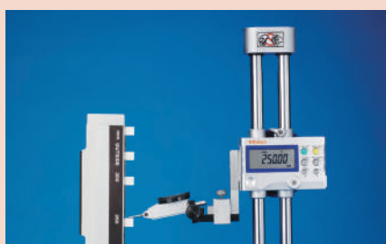
Comprobación de la exactitud del medidor de altura
