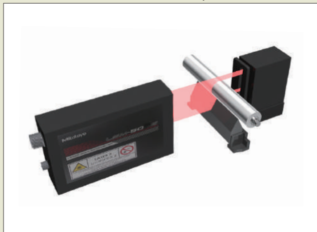
Medición simultánea del diámetro exterior y la deflexión del rodillo
