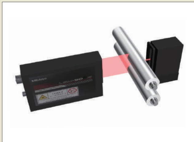
Medición de espacio entre rodillos
