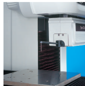
Detector de intervalo amplio utilizando tecnología de control activo
