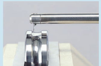
Contorno interior y exterior de un cojinete
