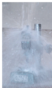
Calificado según la norma IP66 a prueba de polvo/agua y resistencia al aceite mejorada
